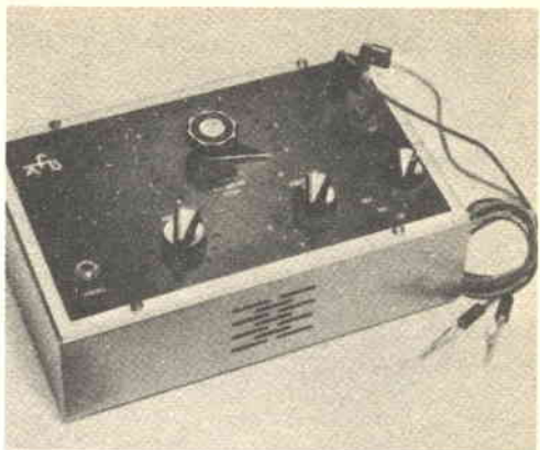
Questo strumento di misura, creato dalla American Foundation for Blinds, permette una lettura tattile delle tensioni, correnti e resistenze. La lettura viene effettuata dopo aver annullato il segnale acustico emesso da un auricolare.
