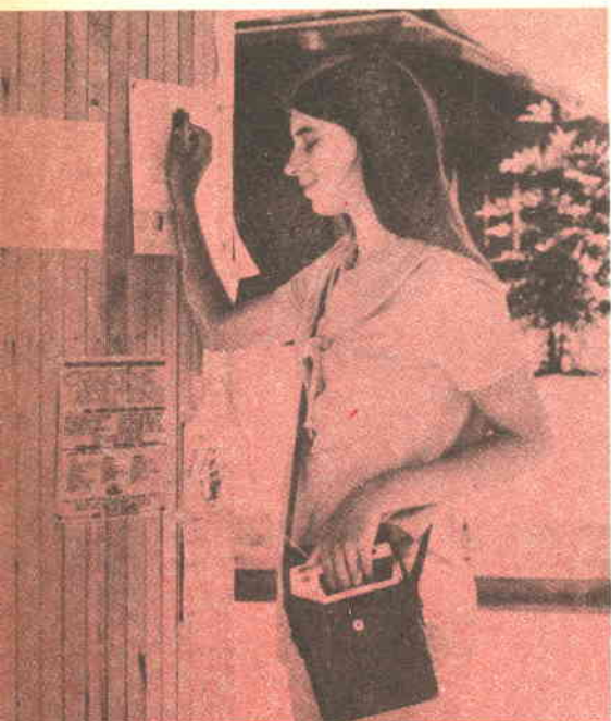
Shari Gabrielson, studentessa della Scuola Superiore di Berkley, legge un avviso esposto nella bacheca della scuola aiutandosi con un Optacon, la macchina sviluppata presso la Stanford University. Mentre la sua mano destra, che tiene la testina di lettura, scorre le righe, la mano sinistra è posata su un gruppo di piccoli stimolatori tattili, che riproducono i contorni di ogni lettera letta. Per riconoscere le lettere è sufficiente il polpastrello di un solo dito.
